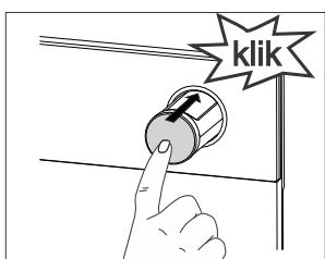
**1** Uklonite spremnik za vodu iz kućišta pritisikom na gumb. Kada pritisnete gumb, spremnik će iskočiti.
